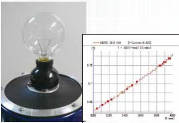
電球内部フェラメントや恒温槽内部のサンプルを計測する場合、ガラスがあって物理的にセンサーを使用することができません。本システムではイメージセンサー方式なのでガラス越しでの計測が可能です。
